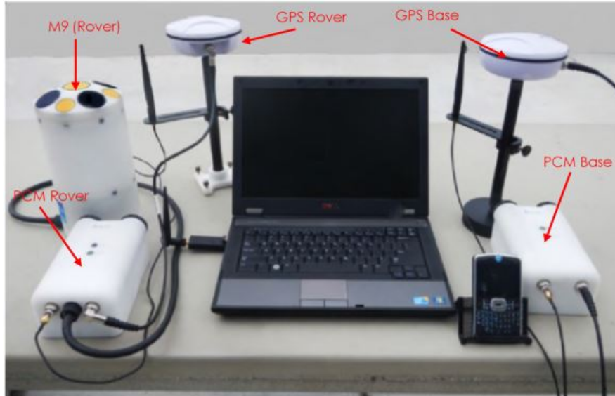
Configuração geral do M9 montado sobre bancada, com GPS e PCMs.
